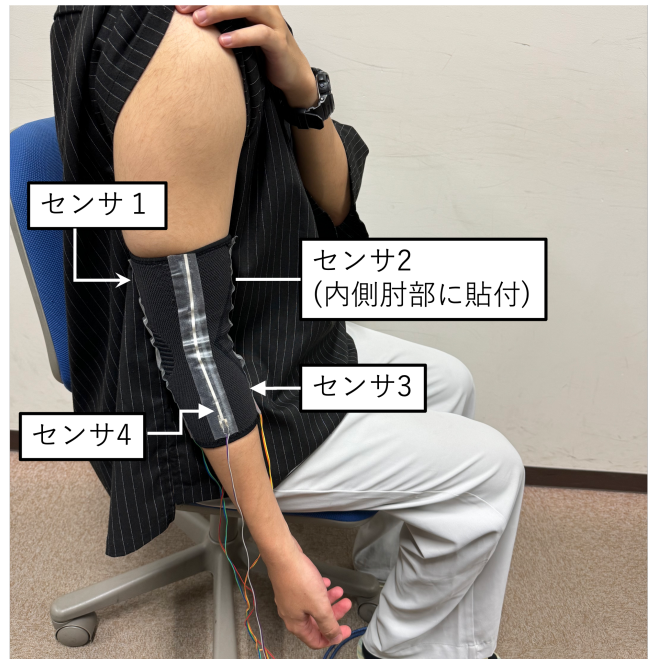
図 3 本デバイスを装着した実験参加者。センサ 1 は肘頭部、センサ 2 は内側肘部、センサ 3 が前肘部、センサ 4 は外側肘部に沿う。
