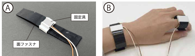
図 3 実験において用いたデバイス。A) 振動を提示するために用いる LRA を取り付けたデバイス。B) LRA を手首および指に装着した様子。
