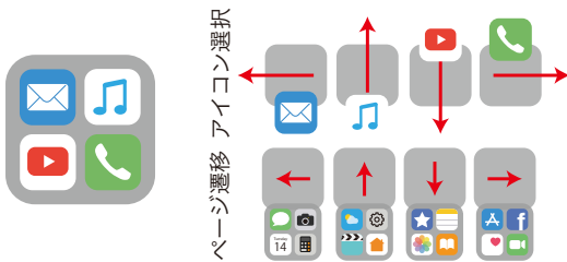
図5. アイコンフォルダに対するショートカット。フリックによってアイコン選択, 提案操作によってフォルダのページ遷移が可能である。
