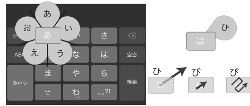
図8 日本語フリックキーボードの拡張. ターゲット内スワイプによって特殊文字の入力が可能である.
