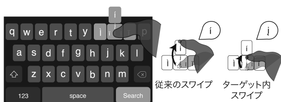
図9 英語キーボードの拡張 [5]. 1度のタップもしくはスワイプによる文字入力が可能である。
