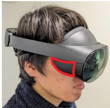
図 4.2: フル遮光ブロッカーおよび Meta Quest Pro を装着したユーザ。左側：フル遮光ブロッカー。右側：Meta Quest Pro を装着したユーザ。フル遮光ブロッカーは、赤枠において囲まれた領域内にある。
