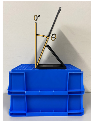
図 4: ディスプレイの角度 \theta の定義. 奥行き方向ユーザ反対側への傾きを \theta とし, ディスプレイ設置平面に垂直な状態を 0 度とする.
