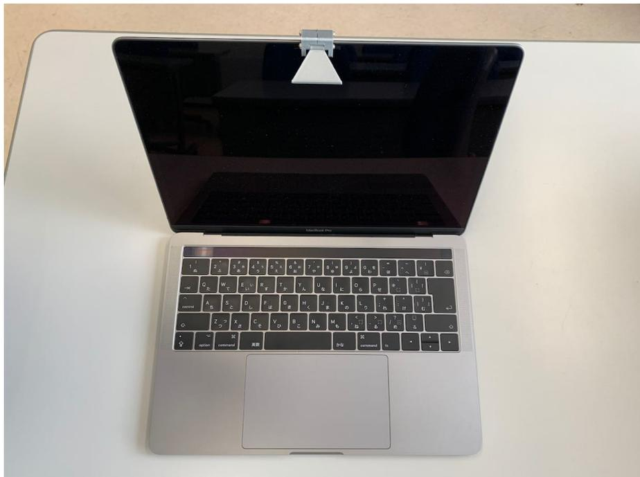
図 5.1: 統制下における実験に用いた機器。ラップトップコンピュータのインカメラに鏡固定具を取り付けている。
