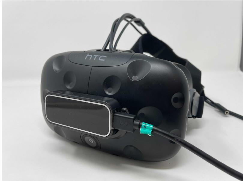
図 4.1: 空中タップを検出するために LeapMotion を取り付けた HTC VIVE.
