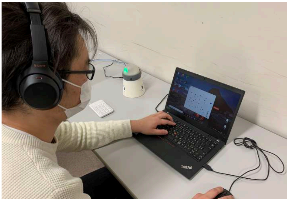
図 3.1: 実験を行っている様子。参加者が作業用 PC にてタスクを行っている間に、左斜め前 45 度方向にアウェアネス情報を提示する。メッセージ受信状態に変化したことに気づいた場合、参加者は左手側に配置されたボタンを押す。
