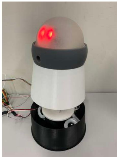
図 5.2: 本研究にて製作した物理アバタ. 先行研究 [TKST21] におけるシステムを拡張した. 物理アバタの視線を制御するために2つのサーボモータおよびフルカラーLEDを用いており, 姿勢を制御するためにさらに2つのサーボモータを用いている. 音声通話用のスピーカを搭載しており, 物理アバタの転倒防止策として, 重心を足下に置く設計にしている.
