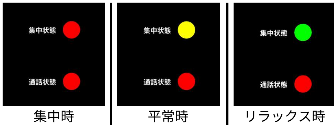
図 6.7: ライト条件において提示される相手の集中度の変化. 左: 相手が集中時はライトが赤色に点灯する. 中央: 相手が平常時にはライトが黄色に点灯する. 右: 相手がリラックス時にはライトが緑色に点灯する.
