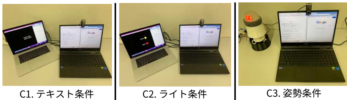
図 6.1: 各条件における実験環境。左：テキスト条件。中央：ライト条件。右：姿勢条件。各条件ともに左斜め前 45 度の方向にアウェアネス支援用 PC または物理アバタが配置された。
