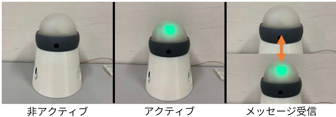
図 3.3: ライト条件において提示されるアウェアネス情報. 左から順に, 非アクティブ状態, アクティブ状態, メッセージ受信状態を示す. 非アクティブ状態は消灯, アクティブ状態は点灯し, メッセージ受信状態においてはライトが点滅する.
