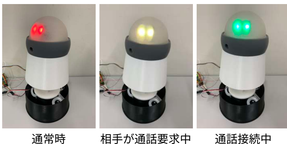
図 5.5: 通話要求に対応する物理アバタの目の色。左：通常時は目は赤色に点灯している。中央：相手のみが自分の方に視線を送っている場合（通話要求中）、目は黄色に点灯する。右：相互注視が行われた場合（通話接続中）、目は緑色に点灯する。
