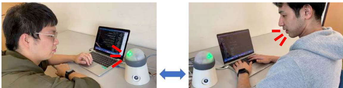
図 2.7: 物理アバタを介して相互注視が成立すると，音声通話が接続される．音声通話接続時は物理アバタの目が緑色に変化する．
