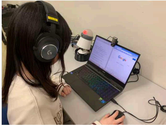
図 6.9: 参加者が実験を行っている様子。参加者は作業用 PC の正面に着席し、左斜め前 45 度の方向に物理アバタが配置された。また、参加者はヘッドフォンを装着し、雑音を排除した。
