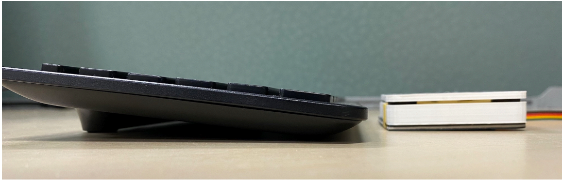
図 4.4: 実験用に作成されたパームレスト．パームレストは，高さがキーボード最下列のキーと同程度の高さとなるように作成された．
