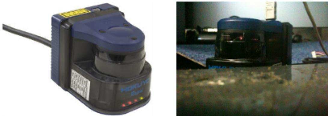
図 4.2: UBG-04LX-F01 の外観 (左) と床に埋め込むようなセットアップ (右)
