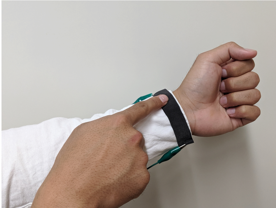
図 4.2 布型タッチインタフェースを衣服の袖部分に取り付けた例.
