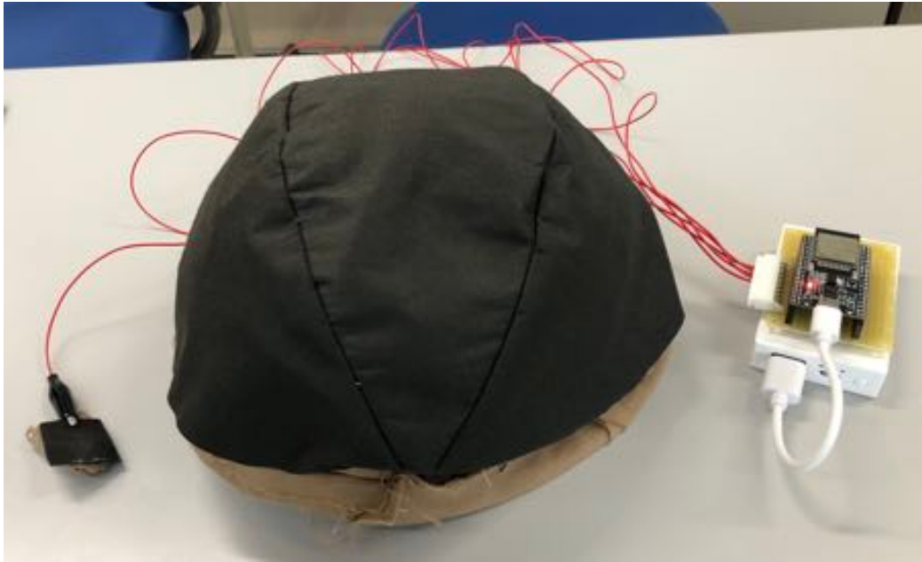
図 3.5: 指に装着した電極からの電圧印加によるタッチ検出を行う帽子型タッチインタフェース
