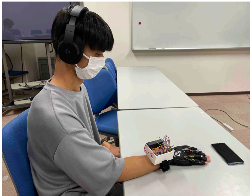
図 7.2: 楽譜を紙ではなくスマートフォンにより提示すること, グローブおよび PC 間の有線による USB 接続をグローブおよびスマートフォン間の Bluetooth による無線接続に変更すること, ならびにピアノ音, 振動, および光の制御を PC ではなくスマートフォンにより行うことにより小型化されたシステムを用いて練習する様子.
