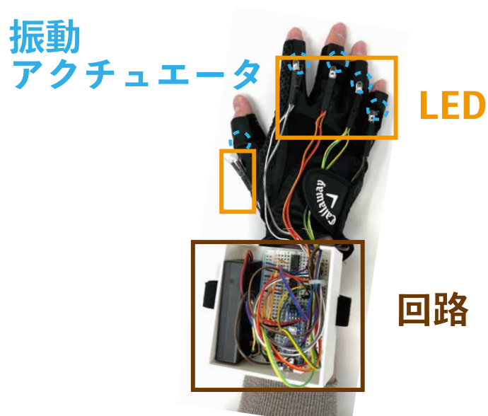
図 4.5: 振動および光を提示するためのグローブ型デバイス.
