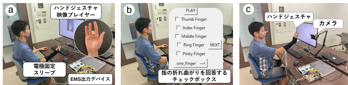
図 7.2: 実験の様子。(a) 電気刺激を提示されながら、電気刺激に連動したハンドジェスチャ映像を見てハンドジェスチャを学習している様子。(b) 学習したハンドジェスチャ動作にて、折れ曲がった指をチェックボックスへ入力している様子。(c) カメラに向かって学習したハンドジェスチャを提示している様子。
