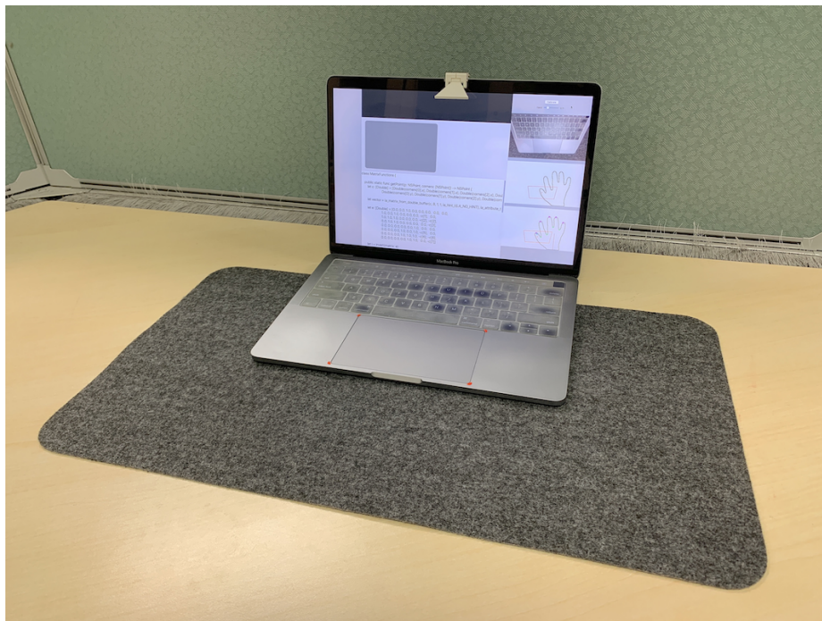
図4.8: インカメラおよびタッチ点の座標データを用いた指の識別システム。
