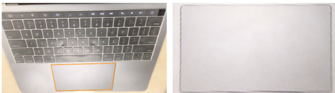
図 5.3: 左) 鏡を取り付けたインカメラから取得されるキーボードおよびタッチパッド周辺の映像. 右) 射影変換により表示されたタッチパッド領域の映像.
