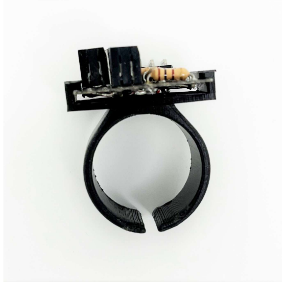
図 4.3: 指輪の上面に設計された両端がコの字型の溝に装着されたユニバーサル基盤.
