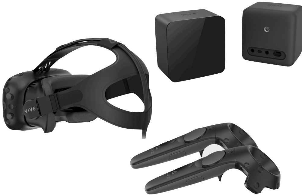
図 1.1: PC や外部センサとの接続が必要な HMD の例 (HTC VIVE, https://www.vive.com/jp/product/ )
