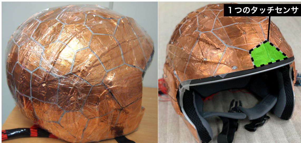
図 3.6: 54 点のタッチセンサを実装したヘルメットの外観
