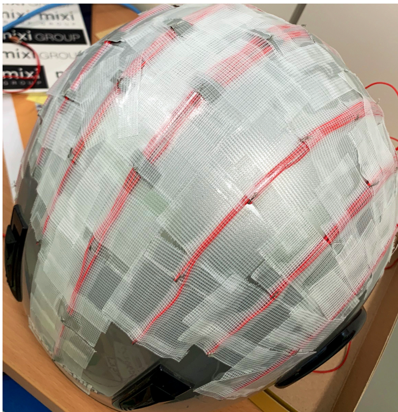
図 3.4: 配線を行なったヘルメットの外観図
