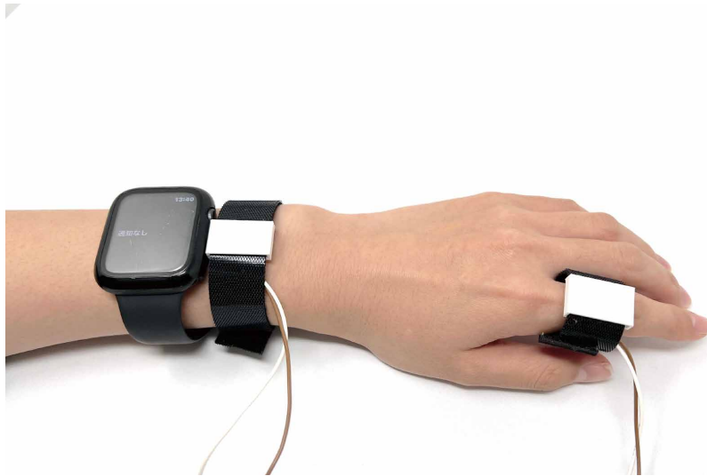
図 5.1: デモにおいて用いたシステム. 3.2 節において示したデバイスに加えて, スマートウォッチを用いた. スマートウォッチおよび手首に取り付けた振動子は, 将来的には統合することを考える.
