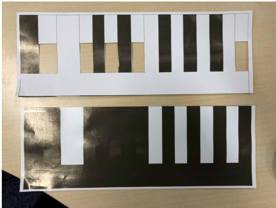
図 3.1: 紙の一部を切り取ることで作製した識別子の構成 .
