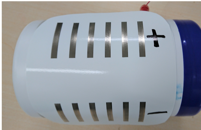
図 6.2: 個人で作製可能なリモコンの例 . ユーザは識別子を指にてなぞることにより , 音量を操作できる .
