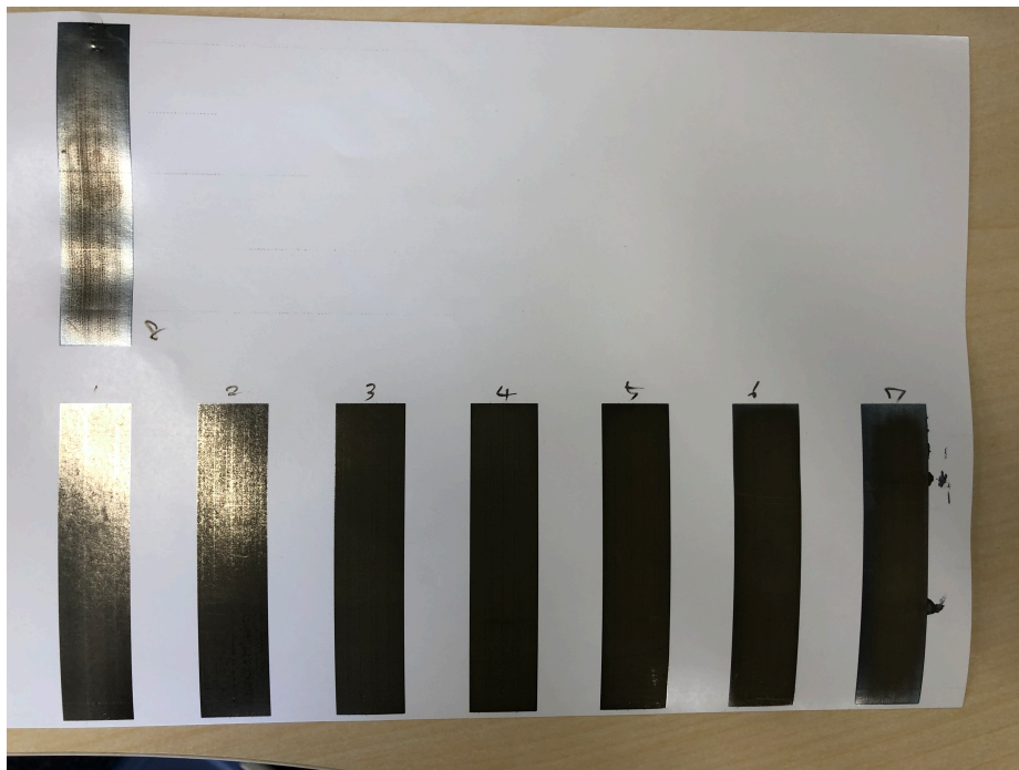
図 3.8: 1-8 層印刷を行った銀インクタッチ電極 .
