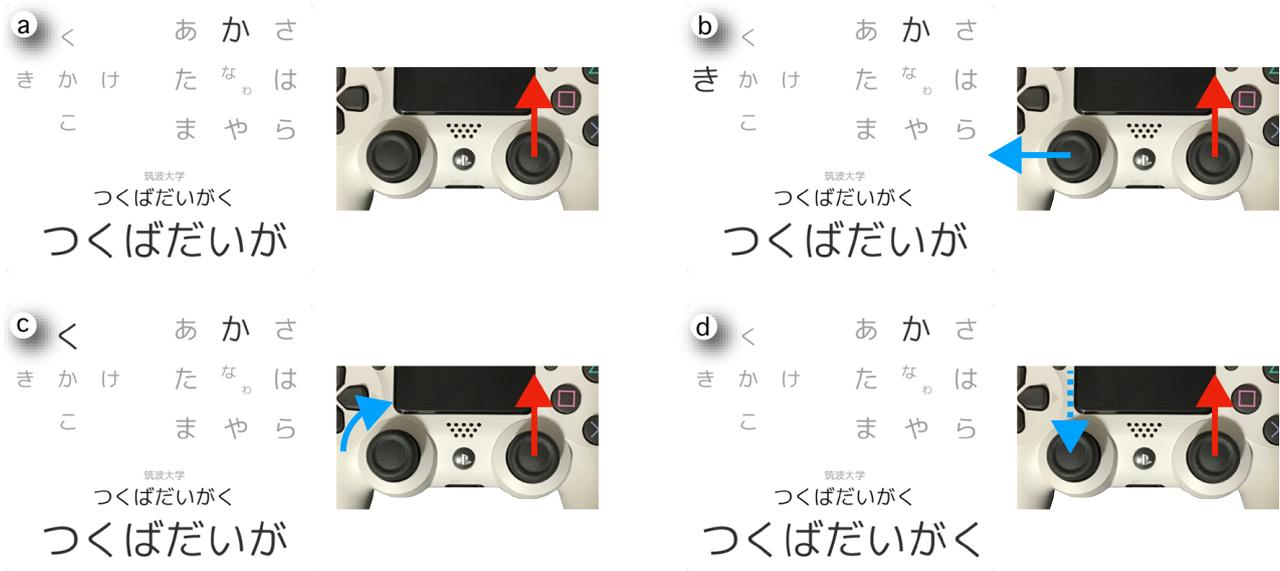
図4 JoyFlick を用いて文字「く」を入力する操作の例. まず, ユーザは右スティックを上倒して (a) 子音「か」を選択する. 続いて, (b) 誤って左スティックを左倒して母音「い」を選択してしまったため, (c) 左スティックを倒したまま, 倒す向きを変えて母音「う」を選択する. 最後に, (d) 左スティックをニュートラルポジションに戻して文字「く」を入力する.
