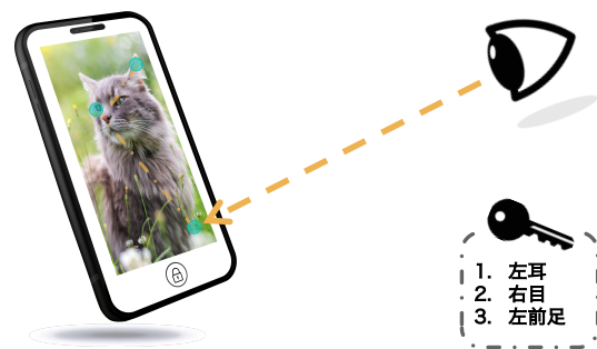
図 1 提案手法を実行するイメージ図。青色の点は鍵として登録した特徴点列内の各点を表しており、オレンジ色の矢印がユーザが認証のために視線を移動させている様子を示している。これらはスマートフォンの画面には表示されず、実際には画面上に画像が表示されているだけである。なお、図はスマートフォン環境での利用を示しているが、スマートフォン環境だけでなく、ラップトップなど他の環境での利用も考えられる。
