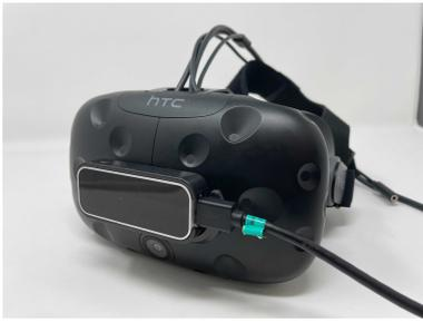
図2 LeapMotion を取り付けけた HTC VIVE.
