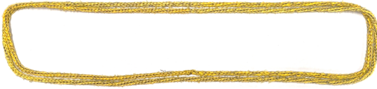
図 1 導電繊維編み込み紐.
