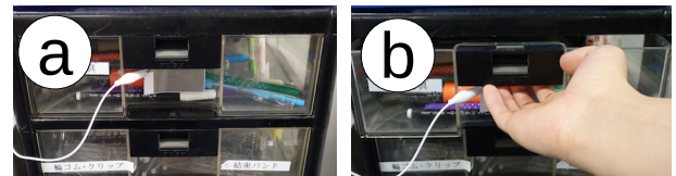
図 25 (a): タッチセンサが貼られている棚 (b): 棚を引く際、タッチセンサに手が触れる様子
