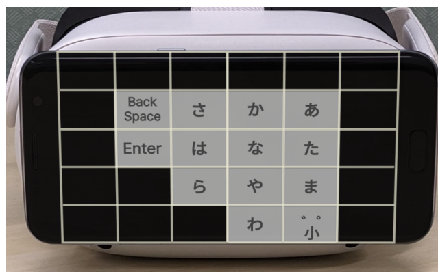
図 3 タッチデバイス上のキーのレイアウト。外側から見た場合、タッチデバイス上におけるフリックキーボードの配置は左右逆になる。
