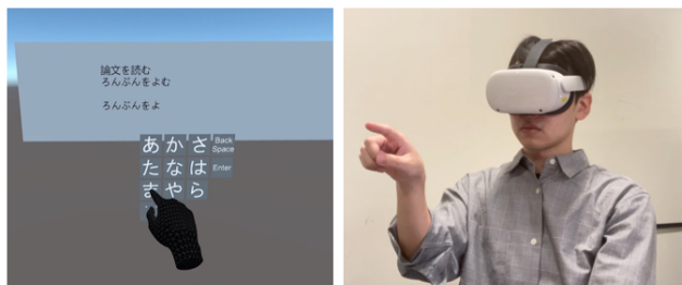
図 4 従来の VR フリック入力手法におけるテキストボックスとキーボードの位置。入力位置はユーザの前方の空中。
