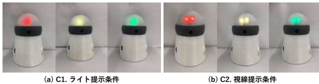
図 5 (a)C1: ライト提示条件における発光の様子。ライトの回転動作は行われない。(b)C2: 視線提示条件における発光の様子。アバタの目は回転動作をする。
