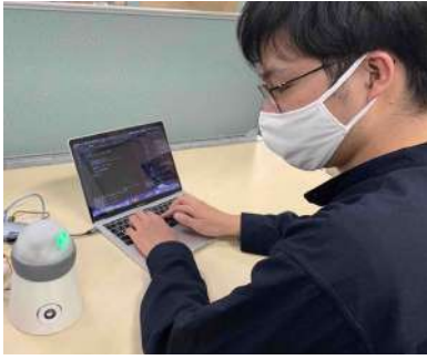
図 1 提案システムを使用している様子。遠隔地間において物理的なアバタを用いて視線情報のやりとりを行い、相互注視が行われた場合音声通話を接続する。
