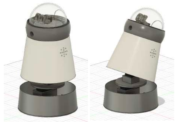
図 6: 物理アバタの作製イメージ図。左図に物理アバタの姿勢が傾いていない状態を示す。右図に物理アバタの姿勢がのけぞる方向に傾いている状態を示す。
