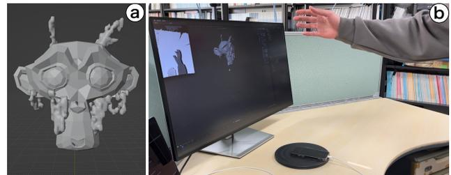
図7 既存オブジェクトの修正。(a) 作例。(b) 既存オブジェクトに対して新たな3次元形状を追加する様子。
