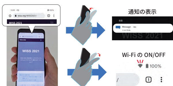
図 1. 提案手法の概要。ユーザは空中にて人差し指によるジェスチャを実行することにより、通知の表示および端末設定の変更を行える。
