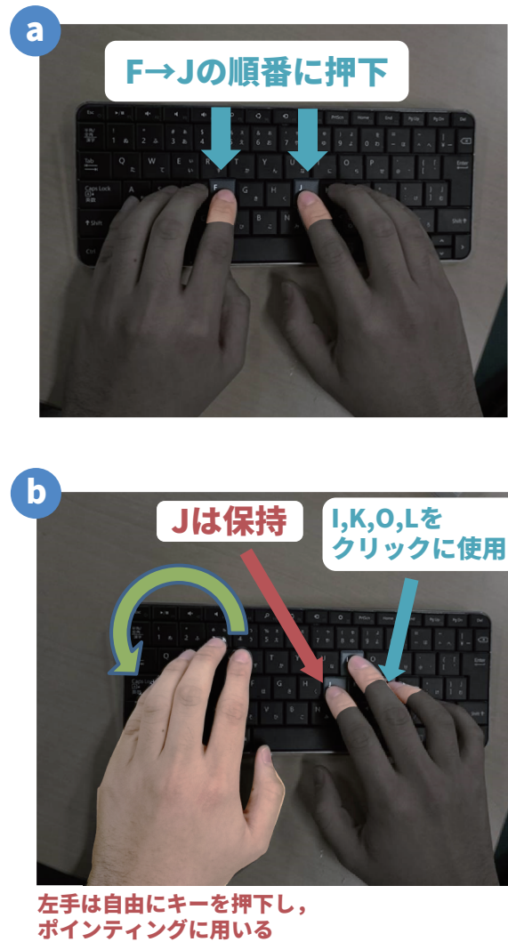
図 1 提案する開始符号およびポインティング操作の操作手順
