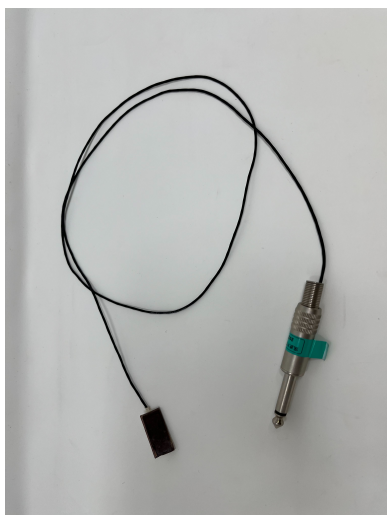
図 1 実験に用いたピエゾ素子およびケーブル。
