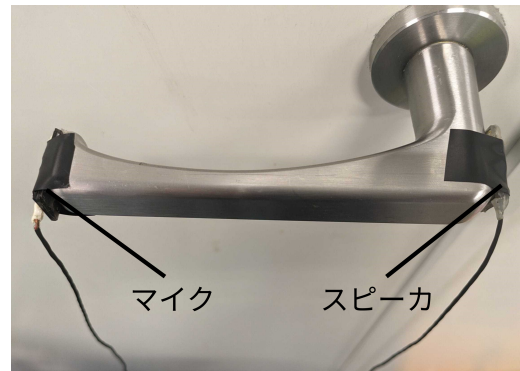
図 2: 実験に使用したドアノブ. 左側にマイク, 右側にスピーカを取り付けている.
