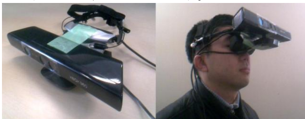
図 4: Kinect 付きヘッドマウントディスプレイ (左)と着用した様子(右)
