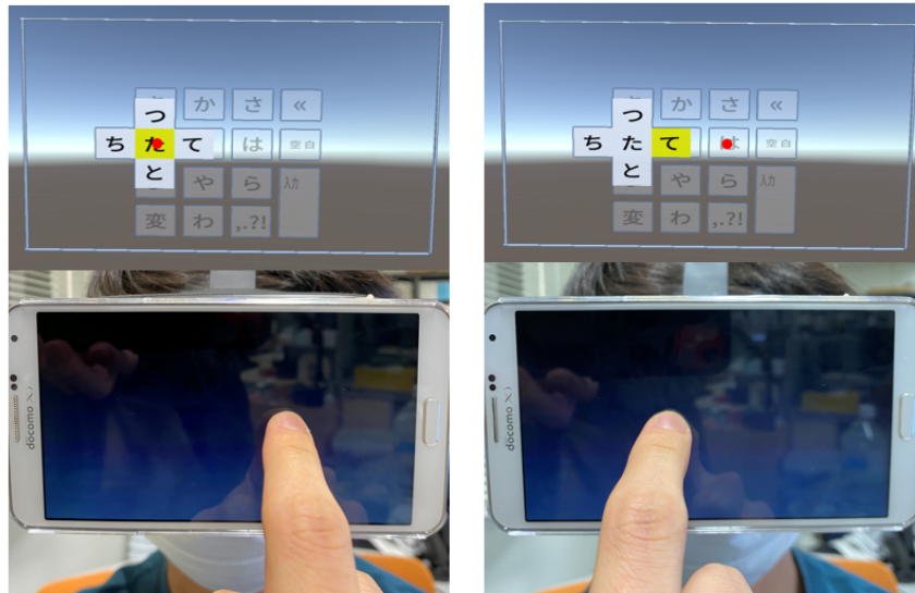
図 3.1: 本手法の入力時の様子. ユーザがタッチデバイスに触れると, VR 内に表示される仮想キーボード上に, 入力位置がポインタとして示される. また, ユーザは表示される仮想キーボードを裏からフリックするように入力する.
