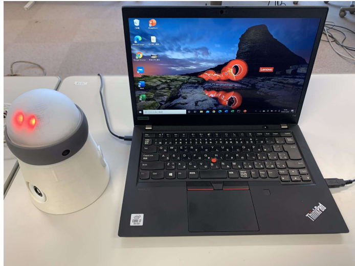
図 5.3: 実験環境. 参加者の左手側約 45 度方向にアバタを配置した. 参加者がアバタに視線を送る際, 明確に視線を移動させる必要を生じさせ, 誤入力を防止した.
