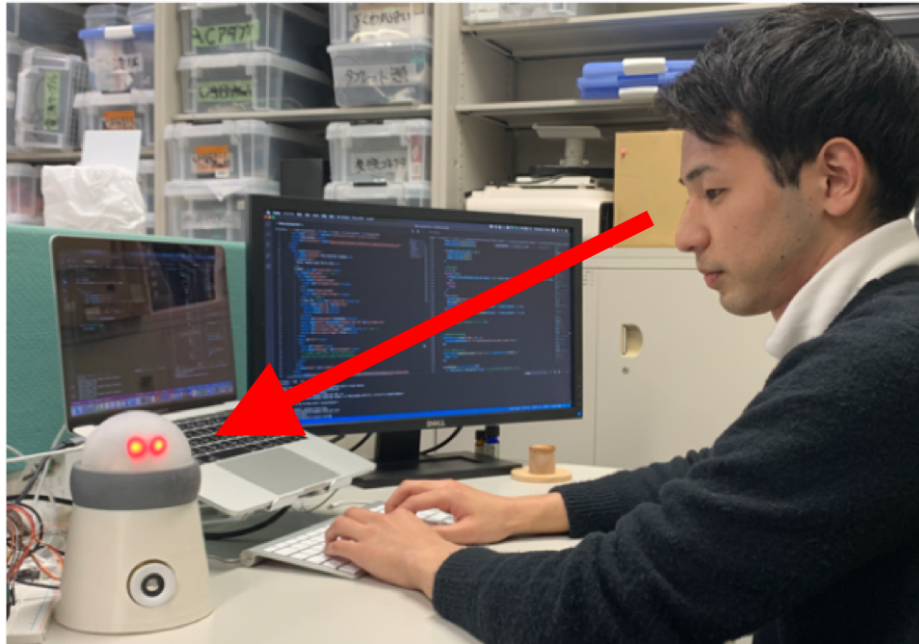
図 4.6: 話し手がアバタの方に視線を送る。ここで、話し手は応答を求める度合いに応じて視線を送る長さを変え、最も強く応答を求める際には呼びかけを行う。
