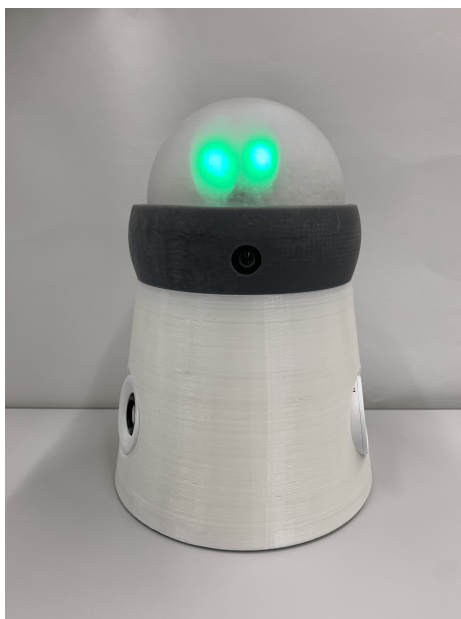
図 1.1: 本研究にて実装した物理的なアバタ. 視線情報の検出および表現が可能である. 遠隔地間における2人のユーザの元に1台ずつ配置することにより視線情報を伝達し合う. アバタを介して相互注視が成立した場合, 音声通話を接続する.
