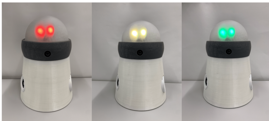
図 4.11: 視線情報による目の色の変化。通常時は赤色に発光しており、相手のみが視線を送っている際には黄色に発光し、相互注視が成立し音声通話が接続されている間は緑色に発光する。
