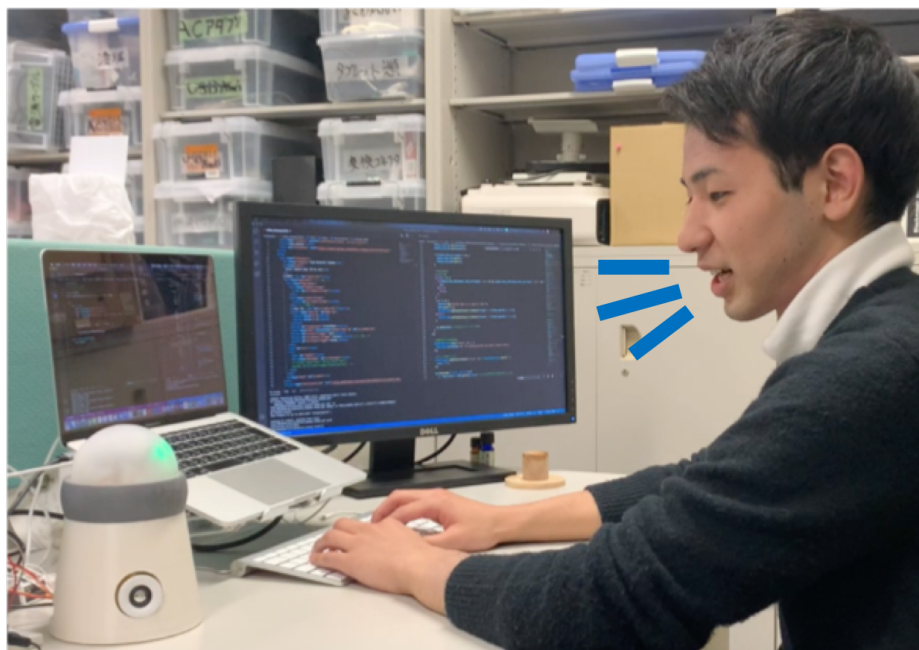
図 4.10: アバタを介して相互注視が成立すると、音声通話が接続される。音声通話接続時はアバタの目が緑色に変化する。
