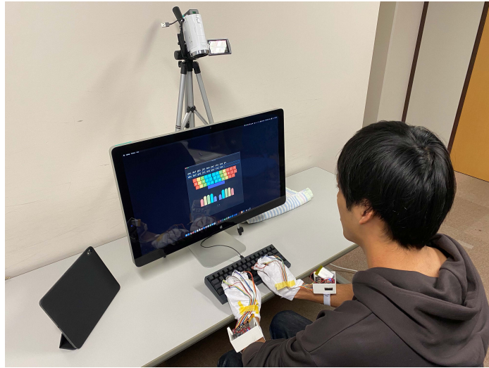
図 5.4: 実験において練習タスクを行っている実験参加者。実験参加者は画面に表示される課題文の入力を行う。手元のキーボードを見ることによりキー配置の情報を手に入れることができないように、実験参加者は無刻印キーボードを用いて入力を行った。
