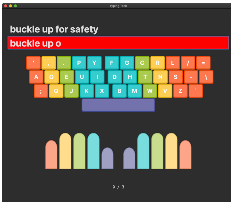
図 4.4: 提案手法にて使用したタイピングアプリケーションのウィンドウ。一番上の行には課題文が表示され、ユーザはテキストボックスに課題文と同じ英文を入力する。画面に表示されているキーボード配列にはどのキーをどの指で押すべきかわかるように色付けされており、キーボード配列表示の下部分にはその色に対応するように色が塗り分けられた指が表示されている。
