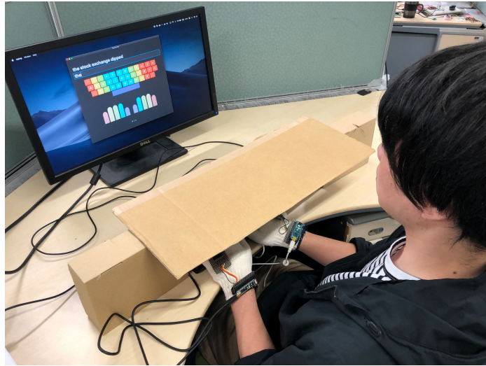
図 4.5: 実験において、練習タスクを行っているユーザ。実験参加者が手元のキーボードを確認できないように、実験参加者は板を用いて手元を隠された状態にて打鍵を行った。実験参加者は両手に触覚刺激提示グローブを装着した。
