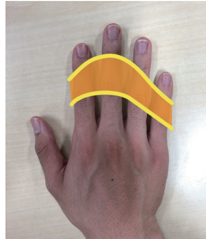
図 4.2: 振動アクチュエータの取り付け位置。振動アクチュエータは各指の橙帯部分にマスキングテープを用いて取り付けられる。
