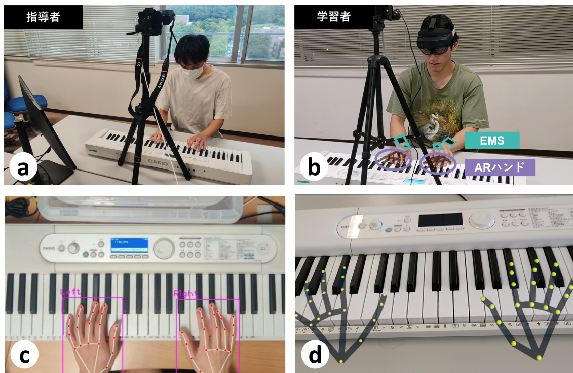
図 1.1: 提案システムを示す. (a) 指導者の演奏を単眼カメラから撮影し, ハンドトラッキング情報を学習者側へ送信する. (b) 学習者は EMS を指に装着し, 指導者の手を模した AR ハンドに手の動きを追従しながら, EMS による指の動きの支援を受ける. (c) 指導者の手の俯瞰映像から関節点を取得する. (d) 指導者の手を模した AR ハンド. 関節点とそれらを結ぶボーンから構成される.
