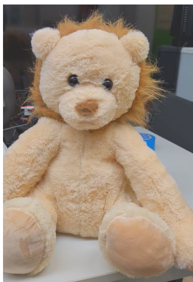
図 3.2: むいぐるみ型テレプレゼンスロボットの正面. ペルチェ素子のモジュールおよびサーボモータを内蔵している.
