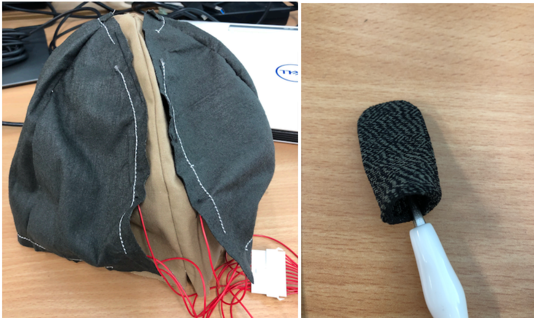
図 4.10: 帽子型タッチデバイスのプロトタイプと導電性指サック
