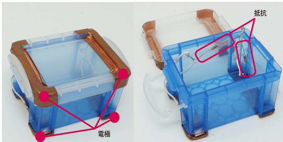
図 4.1: 試作ブロック 1. ポリプロピレン製の箱に抵抗器および電極を取り付けたもの.
