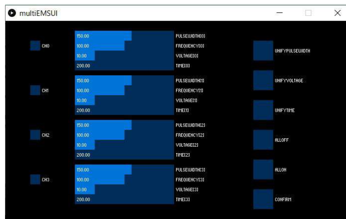
図 3.6: 電気刺激パルス制御用 UI. 電気刺激パルスのパルス幅, 周波数, 電圧, 出力時間を調整出来る.
