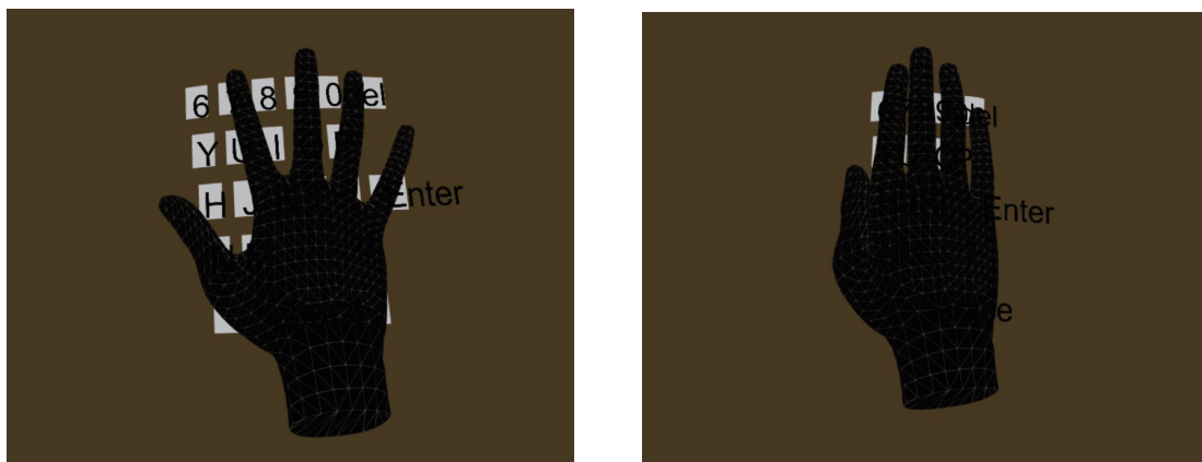
図 3.3: 手の開き具合で拡張が行われるキーボード. 左: 指を大きく開いた場合. 右: 指を閉じた場合.
