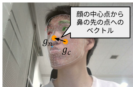
図 3.3: 参加者側のビデオウィンドウにおける対話相手の顔の中心点 g_c , 鼻の先の点 g_n , および顔の中心点から鼻の先の点へのベクトル.
