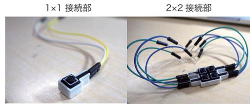
図 4.  $1 \times 1$  および  $2 \times 2$  の接続部のプロトタイプ
