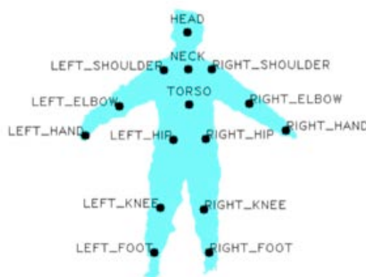
図 3-2. Kinect センサーで取得できる骨格情報のジョイントポイント一覧[7]
