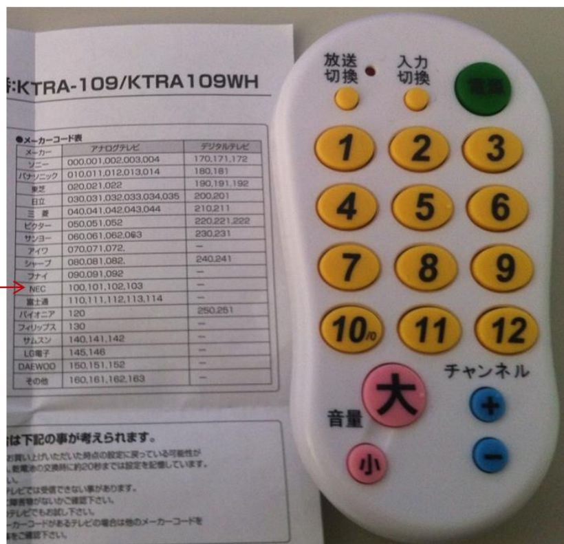
図 8-2 NEC フォーマットを送信できる赤外線リモコン(KTRA-109)
