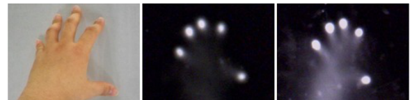
図 4 指の接触 左:表面の様子 中:シリコンタッチパネル 右:アクリルタッチパネル
