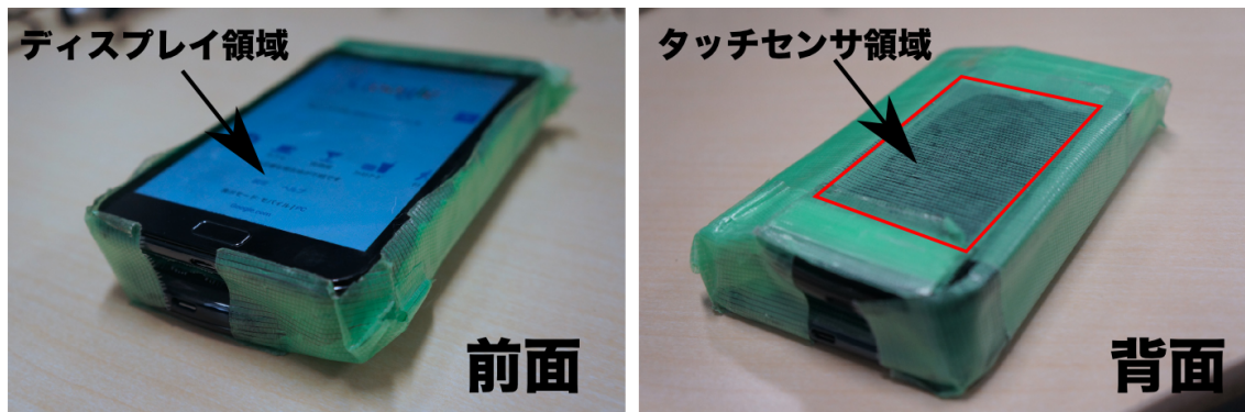
図 4.3: 左：プロトタイプデバイスの前面，右：プロトタイプデバイスの背面
