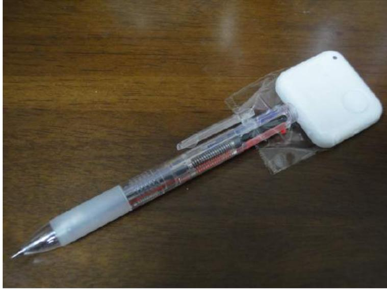
図 3.3: 加速度センサを取り付けた筆記具
